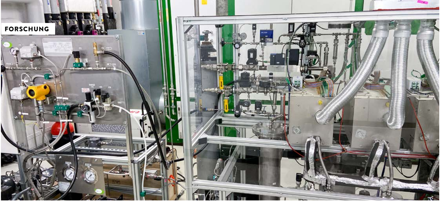
Die vom Wasserstoffspezialisten Siqens entwickelte Demonstrationsanlage arbeitet mit der Hochtemperatur-HT-PEM-Stack-Technologie.
